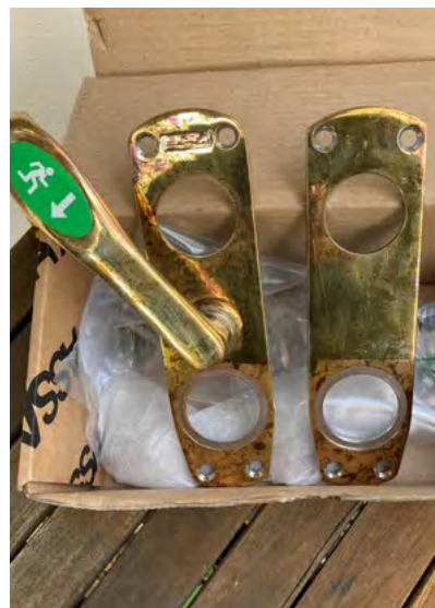
Nödutrymningsbeslag där ytbehandlingen har avlägsnats för att låta mässingen naturligt mörkna och få en åldrad patina.
