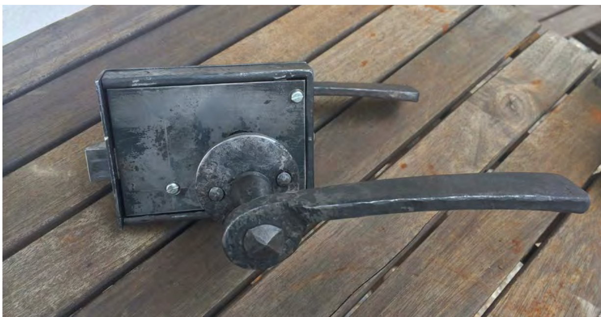
På Gunnebo slott behövde slottscaféet ett nytt kammarlås som skulle vara lättmanövrerat från insidan. Efter samråd med arkitekt valdes en lösning med dubbla fjädrar i låset. Denna tekniska lösning möjliggör ett stadigt dörrtrycke samtidigt som dörren enkelt går i lås.
