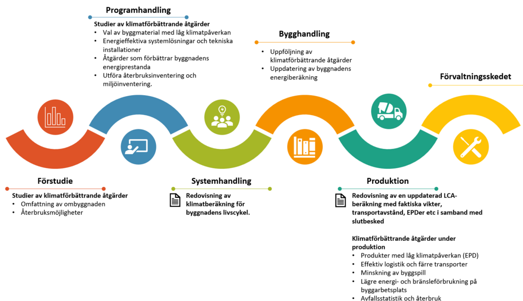
Figur 2: Steg i byggprocessen och skeden med krav på klimatberäkning samt åtgärder för minskad klimatpåverkan. Källa: Ebab
