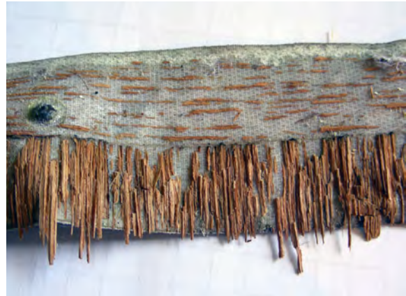
Stark tejp kan förstöra ett helt golv och ska inte användas i känsliga miljöer. Tejpen på bilden tog med sig en bit av golvet när den revs bort. Det finns blå tejp som konservatorer använder. Den har en lägre vidhäftningsförmåga, men fungerar ändå bra. Allra helst bör tejp undvikas. FOTO: LISA NILSEN.
